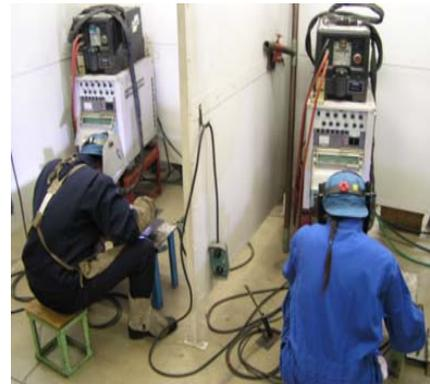
TIG溶接実習。難易度が高いチタン材の溶接を行っているところ。(チタンは他の金属より、溶接時に溶接棒が材料から離れにくいいため、材料の厚さによる電流値や電極と材料の距離などを調整するための高い技能が必要となる。)
