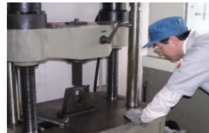
6か月目「溶接の検査、試験」 破壊検査(溶接部の硬さ試験)、非破壊検査(超音波深傷試験)に関する技能及び関連知識を習得
