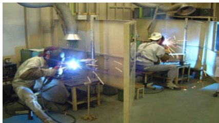
1か月目「被覆アーク溶接作業」 溶接の基本である被覆アーク溶接(手溶接)の技能及び関連知識を習得
