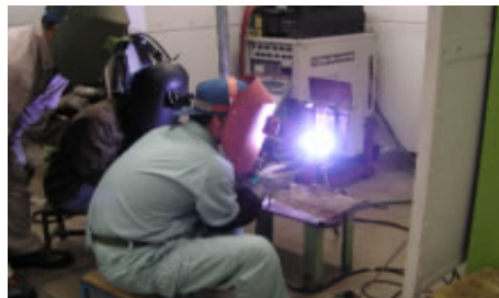
5か月目「TIG溶接作業」 非鉄金属(アルミニウム合金・ステンス鋼等)の溶接技能及び関連知識を習得
