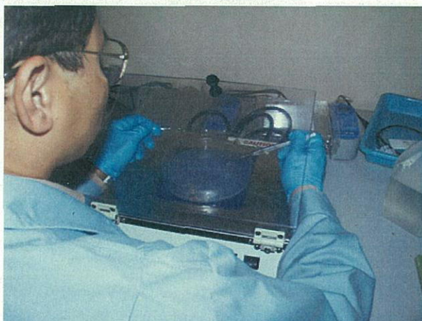
⑨シャーレをトランスイルミネーターに設置、キャンドリング確認
