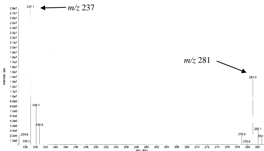
図1 ベダプロフェンのマススペクトル
