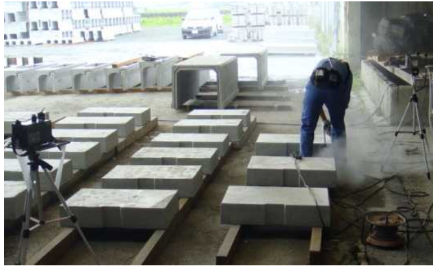
図 2.4 コンクリートに対する研磨・ばり取り作業の測定
