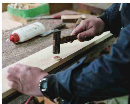
1つ1つの節を手作業で埋めていきます
