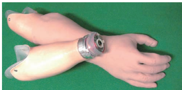
手首部分の新開発によりバッテリー及び回路の小型化などに成功
