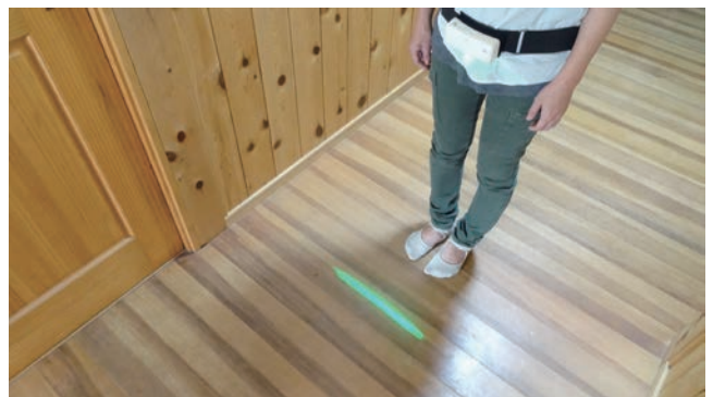
LED光を床に照射しラインを映して視覚キューに
