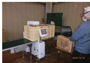
コンベア式の測定器で測定（1分程度）
