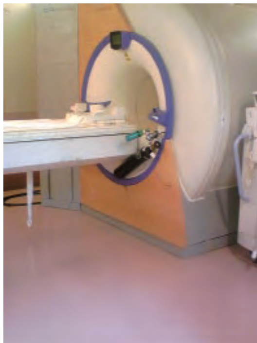
図表Ⅳ - 1 - 3 MRIに吸着した酸素ボンベ
