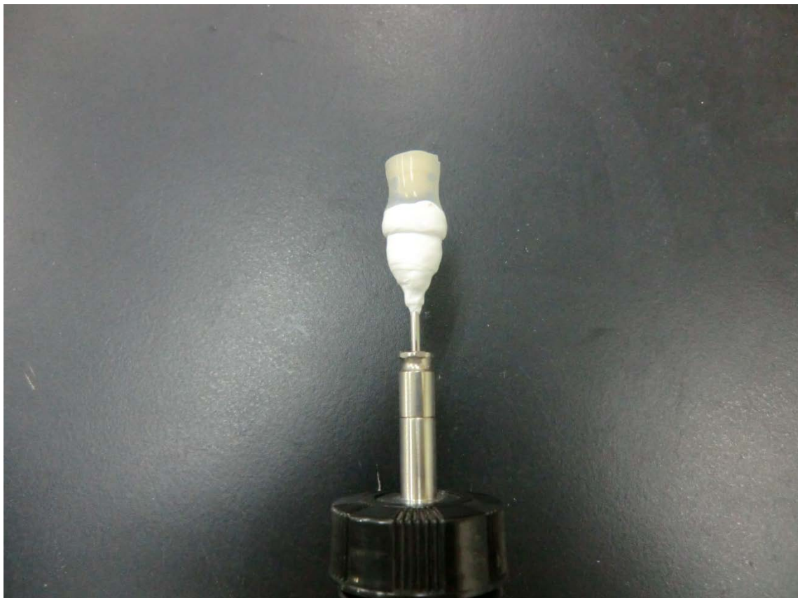
写真1 試料採取用治具 (GC 注入口ゴム栓、横穴針、ガラス製シリンジ)
