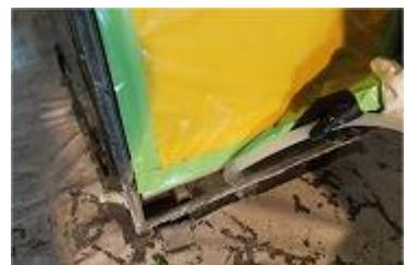
③スモークテスターでの確認で異常がなければ、新しい1次フィルタ、2次フィルタを装着する。
