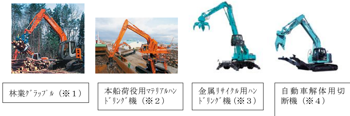
図4 解体用ではない「つかみ機」及び「切断機」の例 (車両系建設機械には該当しないもの)
