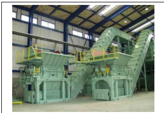
図 4-3 破砕機の屋内設置の例
