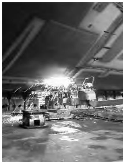
屋外における、船体部分の被覆アーク溶接作業を対象に、延べ 2 名の作業者について、個人サンプラーによる粉じん濃度の測定、粉じん濃度の経時的変化及び粉じんの 10 分間移動平均濃度の推移を測定した。
