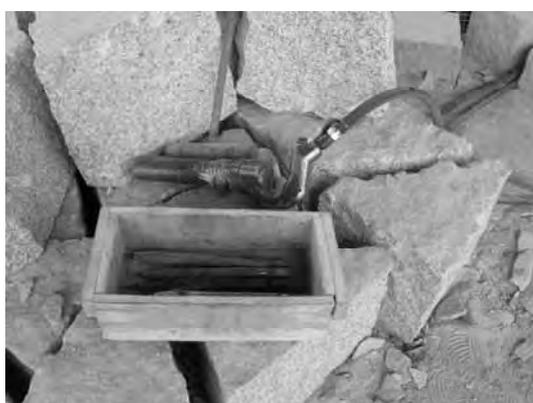
屋外における、小割り作業場所での手持ちチップングハンマー（鑿）による石材の削孔作業を対象に、延べ4名の作業者について、個人サンプラーによる粉じん濃度の測定、粉じん濃度の経時的変化及び粉じんの10分間移動平均濃度を測定した。
