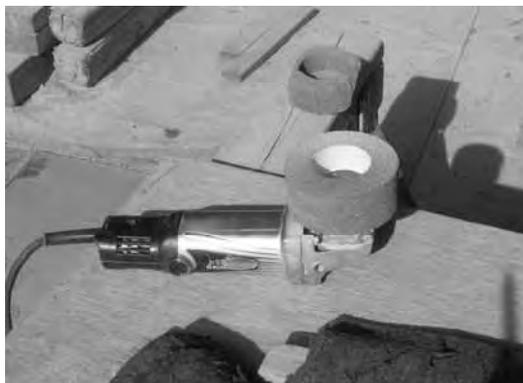
1 方向開放型作業場における、手持ちグラインダによる石材の研削作業を対象に、延べ 3 名の作業者について、個人サンプラーによる粉じん濃度の測定、粉じん濃度の経時的変化及び粉じんの 10 分間移動平均濃度を測定した。
