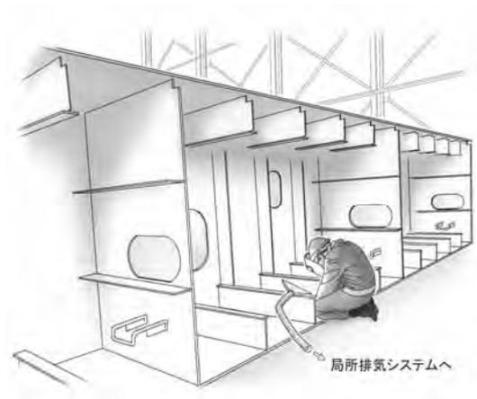
図 50-2 屋外アーク溶接作業への応用例 2
