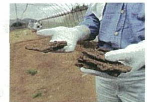
写真5：ポリイオンにより固化した土壌
