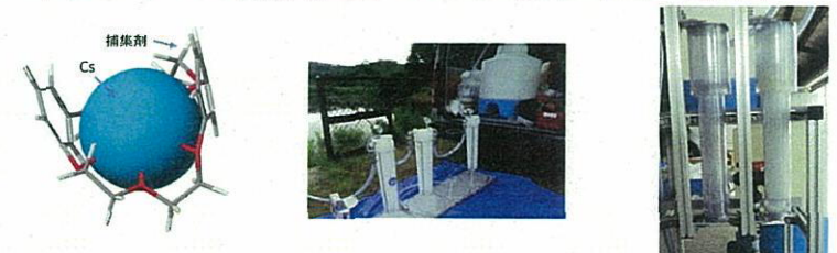
図6：クラウンエーテル捕集材によるセシウム吸着構造(左)とセシウム除去処理装置(中：プレフィルター、右：トルネード吸着塔)
