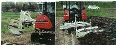
図1：ジョインター付きプラウ（耕深 30cm、トラクタ牽引）：本宮市、5月9日実施
