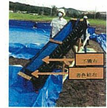
図4：除染フィルターによる実証試験
