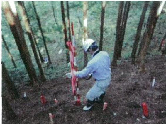
写真5 除去後の空間線量率の測定
