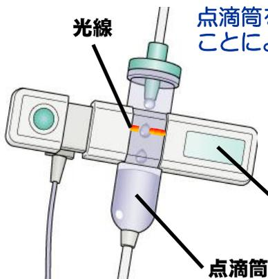
点滴筒を落下する薬液が光線を遮ることにより、滴下数をカウントします。
