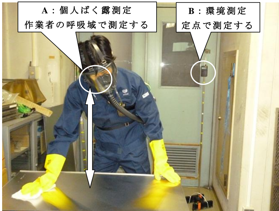
図7. 実施したブランケット拭き取りの模擬作業
