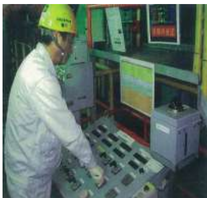
テンションレベラーによる歪み矯正作業
