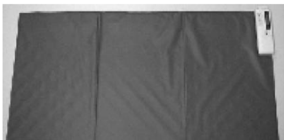
図1：無拘束型多点感圧シートセンサの外観
