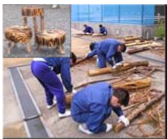
【木材の外皮むき作業】
