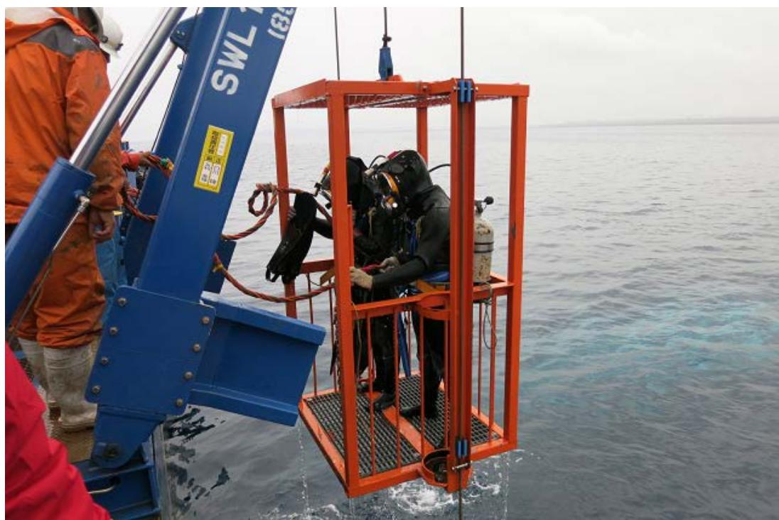
写真 3-1 ダイバー揚収装置を利用して浮上するダイバー
