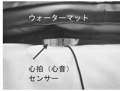
図 2 心拍 (心音) センサー部
