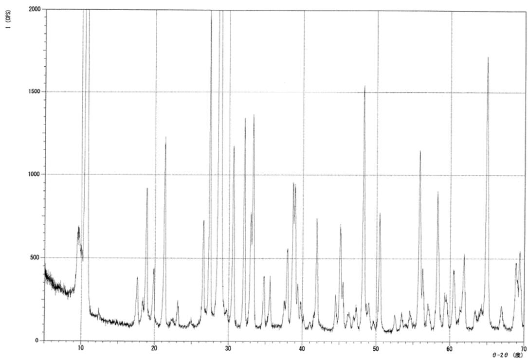
図8. トレモライト/アクチノライト JAW431 のX線回折パターン
