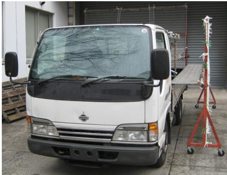
据置型作業床をあおりに取り付けた状態
