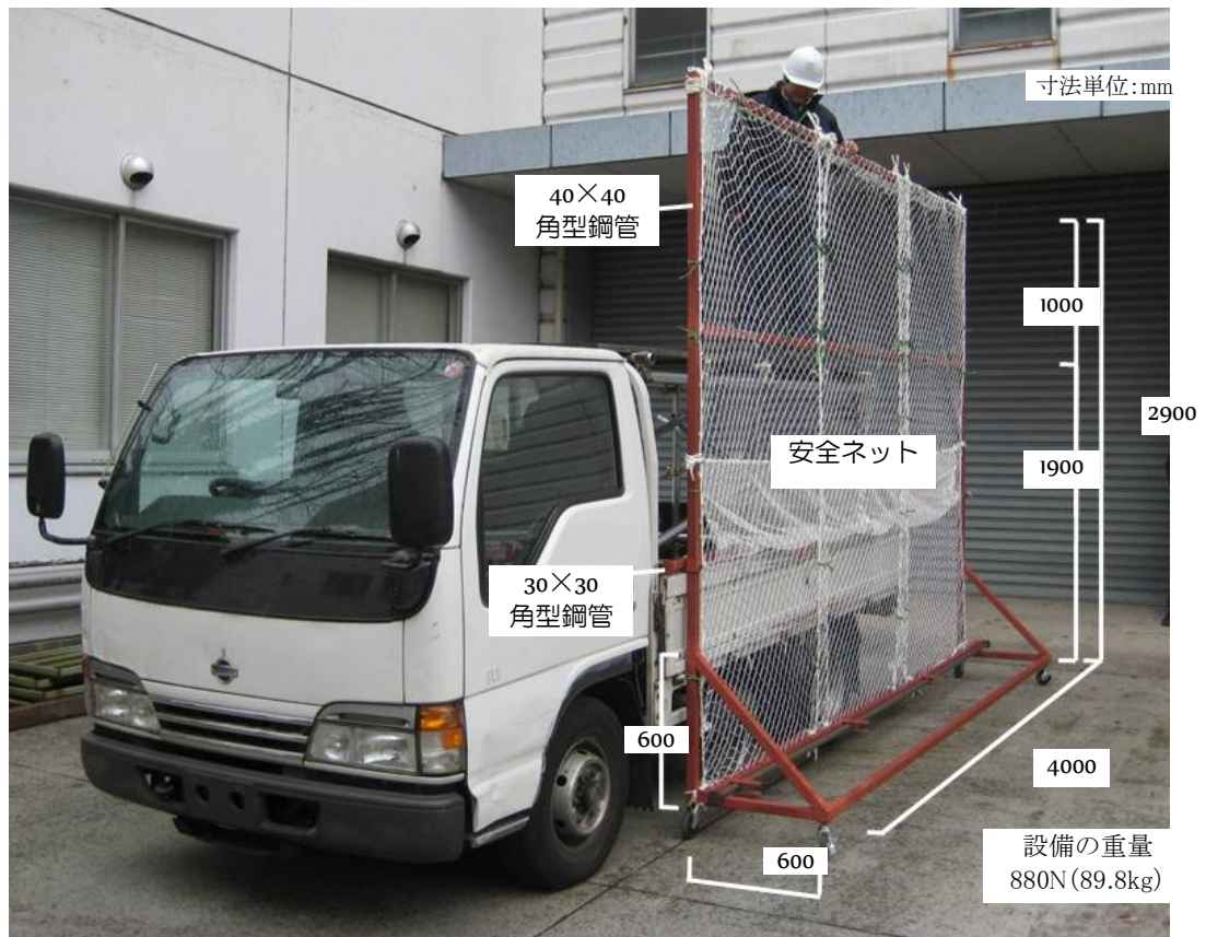
荷主庭先据置型の墜落防止柵を荷台の横に取り付けた状態
