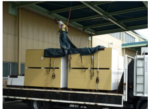
シート掛け作業（2）
