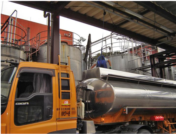
建屋天井に設置したレールと安全带
