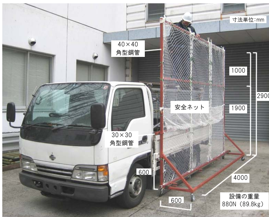
図3-11 荷主庭先据置型の墜落防止柵を荷台の横に取り付けた状態
