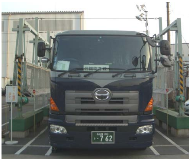
図 4-34 墜落防止柵を使用していない状態
