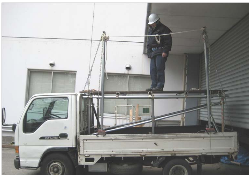
図 3-16 作業員墜落時に支柱が倒れないよう、チェーンとターンバックルで斜め後方に控えを取った状態
