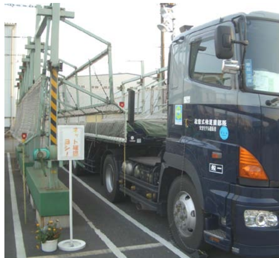
図 4-35 墜落防止柵を使用した状態（作業時）
