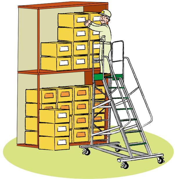
倉庫内の保管棚には、天井直下まで包装資材が積み上げられていたが、倉庫内が狭く昇降階段は設置されておらず、高所からの取り出しは、脚立を使用して行っていた。
