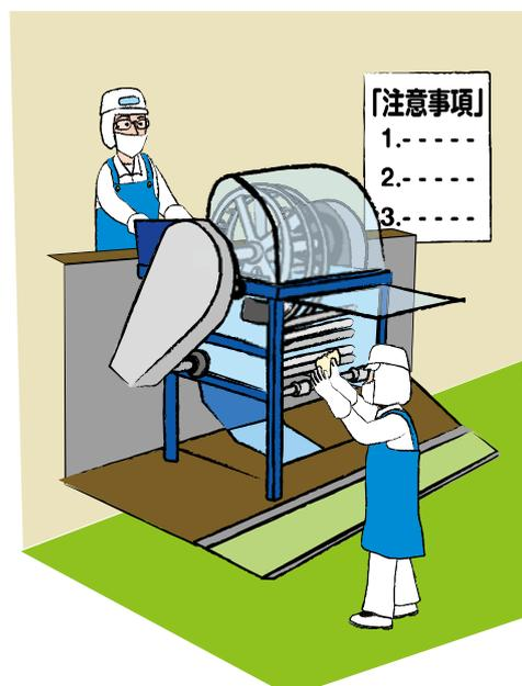
ローラにはカバーを取付け、誤って起動ボタンに触れても、カバーを開けると機械が停止する安全装置を設けた。
