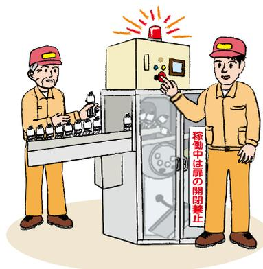
警告ランプを設置して、ボトルの噛み込みが発生した場合は、瞬時に分かるようにした。
