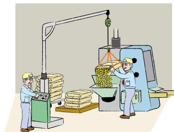
移動式の電動リフターを倉庫及び加工場にそれぞれ設置し、運搬及び仕込み作業を半自動化した。
