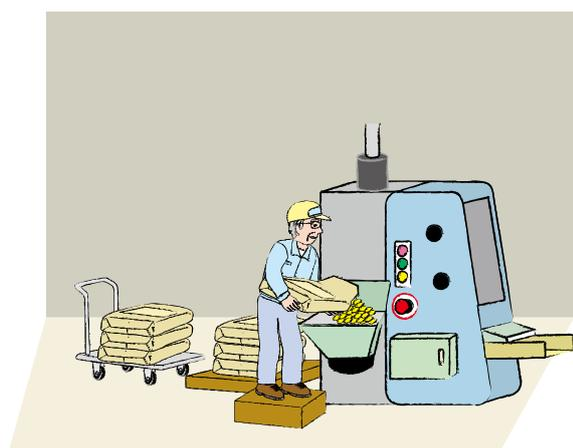
成型機横に積まれた合成樹脂ペレットを成型機仕込み口まで人力で持ち上げてホッパーに仕込むという作業の連続で、腰への負担が大きかった。
