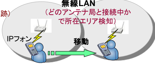
無線減衰度で距離算出する位置検出ではセンサーネットワークもある(「接近警告」で解説)
