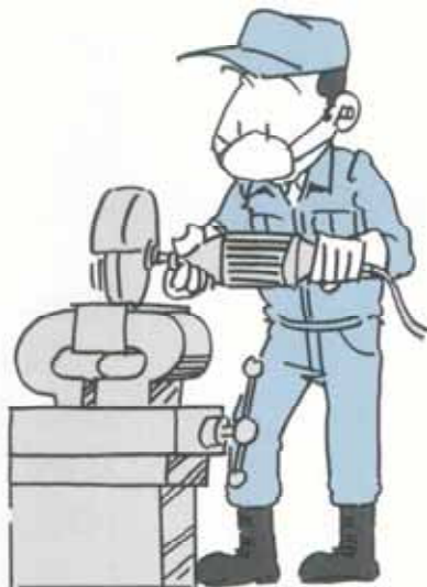
携帯用研削盤での作業
