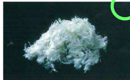
アスベスト繊維(クリソタイル)
