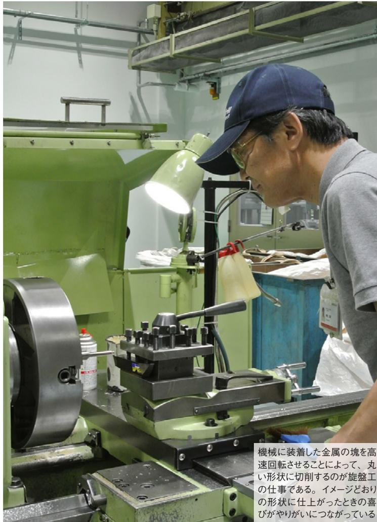
機械に装着した金属の塊を高速回転させることによって、丸い形状に切削するのが旋盤工の仕事である。イメージ通りの形状に仕上がったときの喜びがやりがいにつながっている
