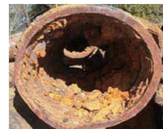
〔水道管の経年化による内面腐食〕
