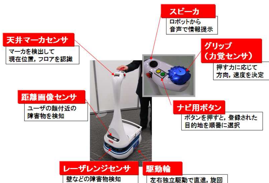
図 1 視覚障がい者向けガイダンスロボット
