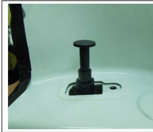
図2 スプリング式は、約4mmの遊びと、伸び率が約250mmある
