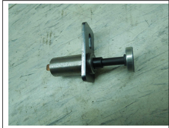
図2 スプリング式は、約4mmの遊びと、伸び率が約250mmある
