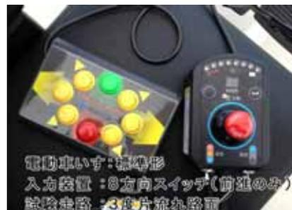
図3：スイッチ入力装置
