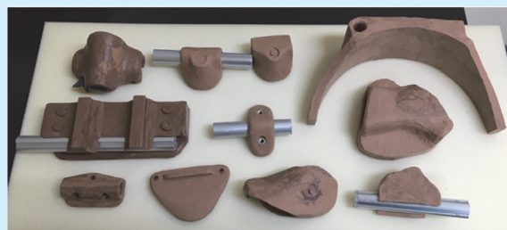
アイデア出し、2次元設計から、3次元設計にかかる前のクレイ(粘土)によるモデル
