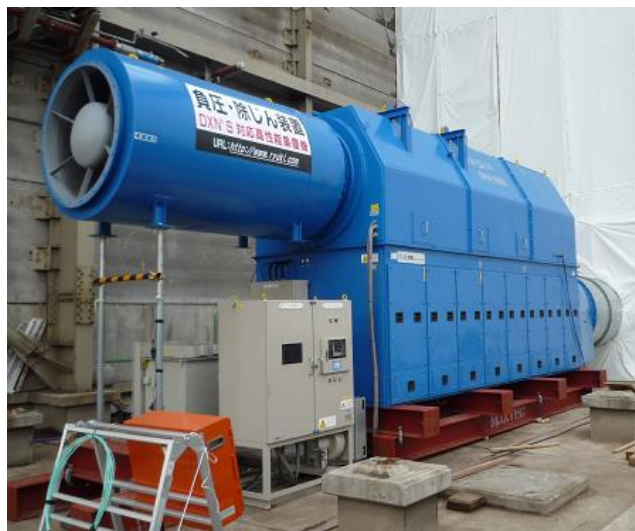
写真X-1 大型集じん・排気装置の例（定格風量1,800m 3 /分）
