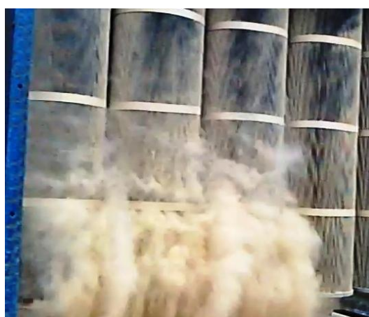
写真X-3 フィルタ自動再生状況
