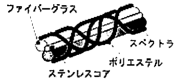
スペクトラガード糸の構造図
