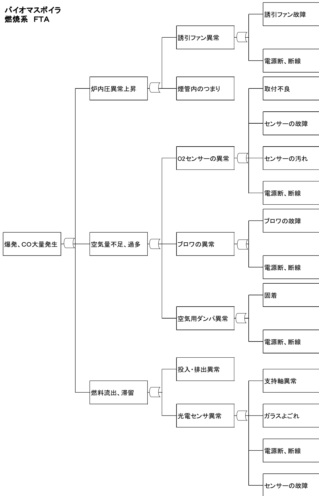
図 2-8 バイオマスボイラーの FTA 例
