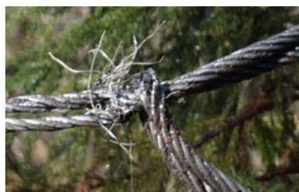
写真 7.4 実地検証で確認した断線が激しい架線ワイヤー
