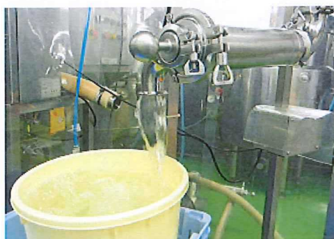
配管に水と鉄粉を流し吸着率を確認する。
