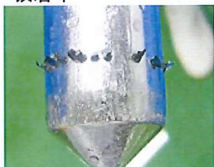
鉄粉10個中10個、全てマグネットに吸着。
