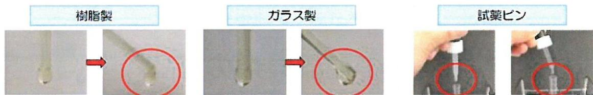
先端の太さや材質により異なる。たとえば、スポイトを傾けると 壁面を伝って1滴の量が多くなるものもあれば（ガラス製）、逆に少なくなるものもある（樹脂製など）ので、事前に1滴の量を知っておくことが大事である。|
