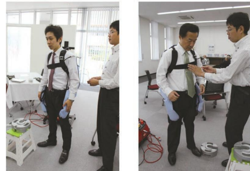
イベント開催時に介護ロボットをデモ展示した。マッスルスーツ（着用型筋力補助装置）を医師会員が試着し、50kgの重量を軽々と持ち上げる機能を確認した。介護労働は重力との戦いである。
