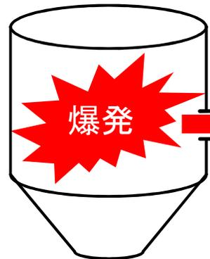
爆風等を外部へ放出し、容器の破裂を防止
