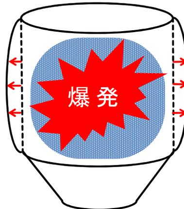
爆発で発生した圧力を設備が変形することで吸収し、設備が破壊されることを防止できる構造等を有する場合、爆発戸等の設置を免除する。※
