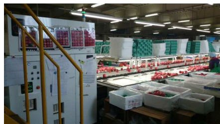
大型の非破壊測定装置による褐変リングの選果
