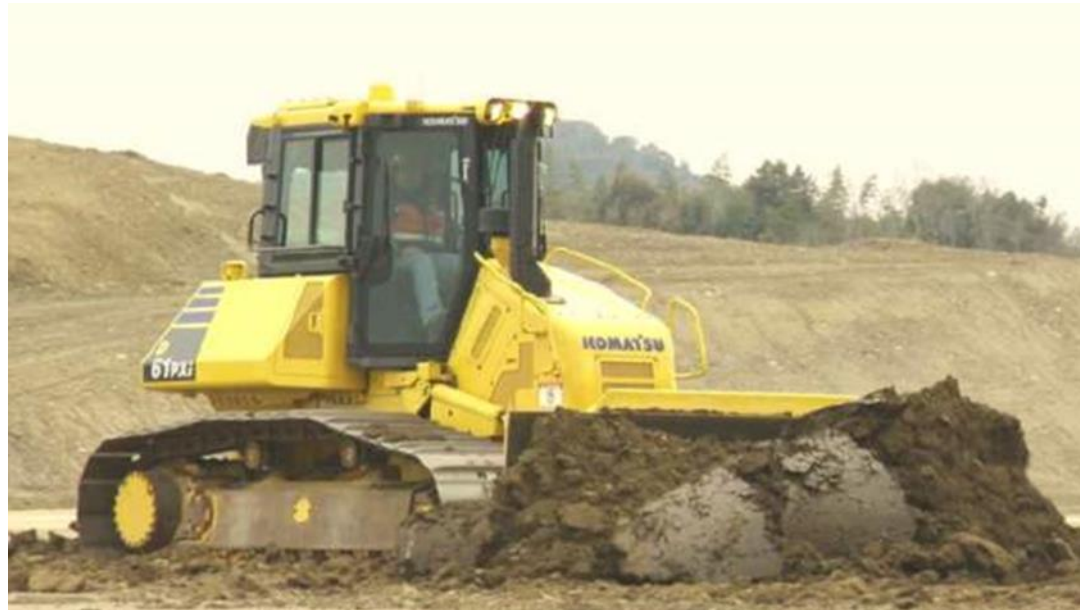
全自動ブレード制御機能搭載 ICTブルドーザー「D61PXi-23」
