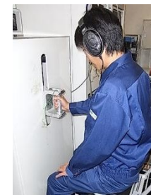
騒音/手腕振動複合ばく露実験
