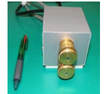
図2 双極性防爆構造除電器
