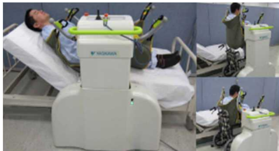
メカトロニクス技術を活用 した移乗アシスト装置 (株式会社安川電機)
