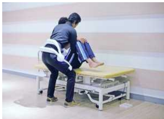
移乗介助支援 用ロボットスー ツHAL (CYBERDY NE株式会社)
