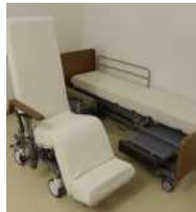
メカトロニクス技術を活用 した移乗アシスト装置 (株式会社安川電機)
