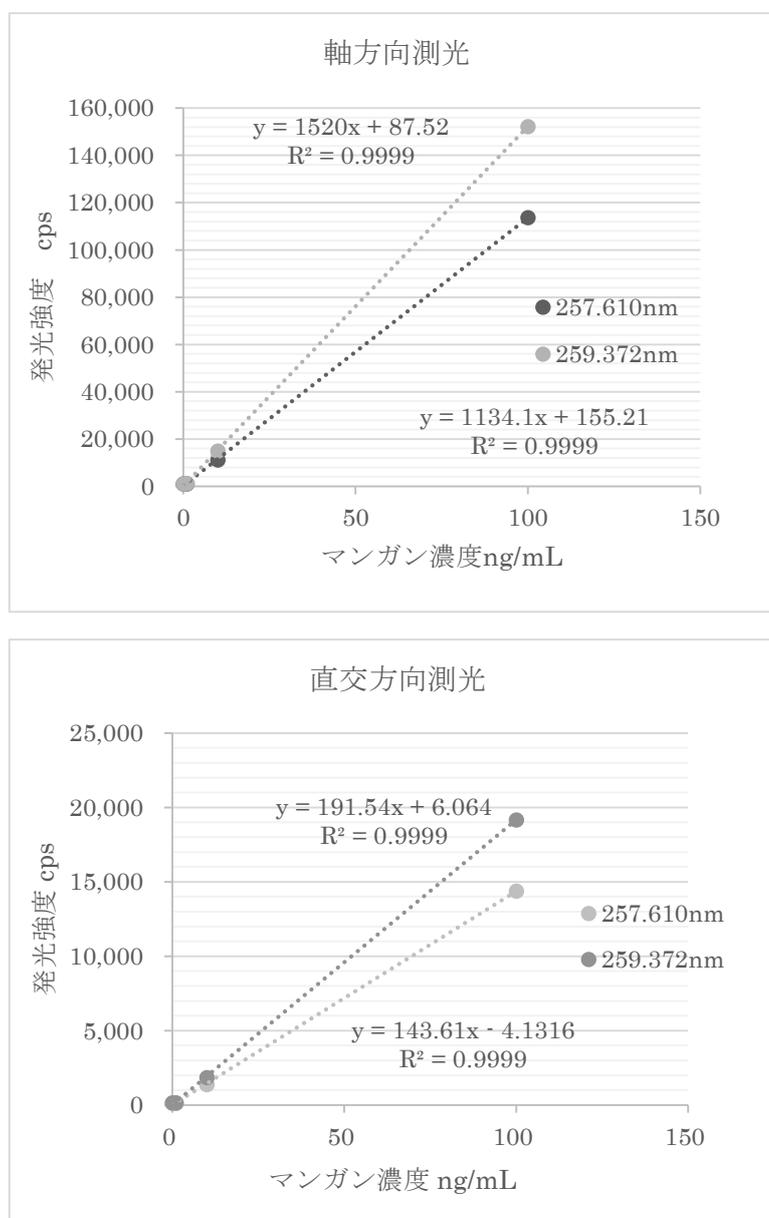
図 3 ICP-AES の検量線例 (各点は 5 回測定)
