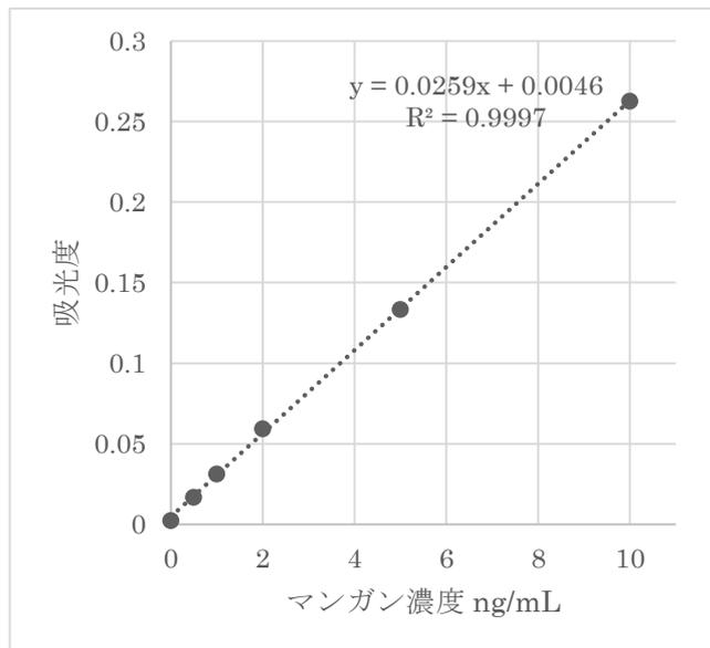
図 2 電気加熱式原子吸光の検量線例 (各点は 3 回測定)
